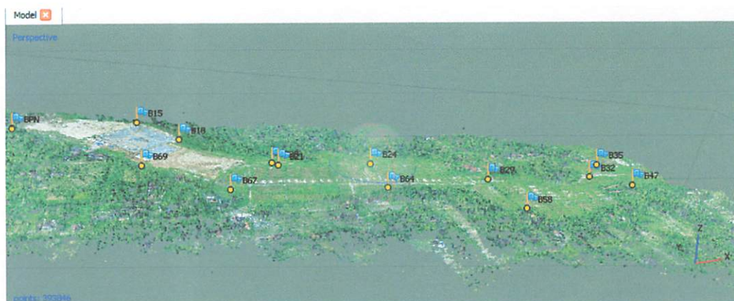
Gambar 3.18. Posisi point cloud yang telah ter-georeferensi
