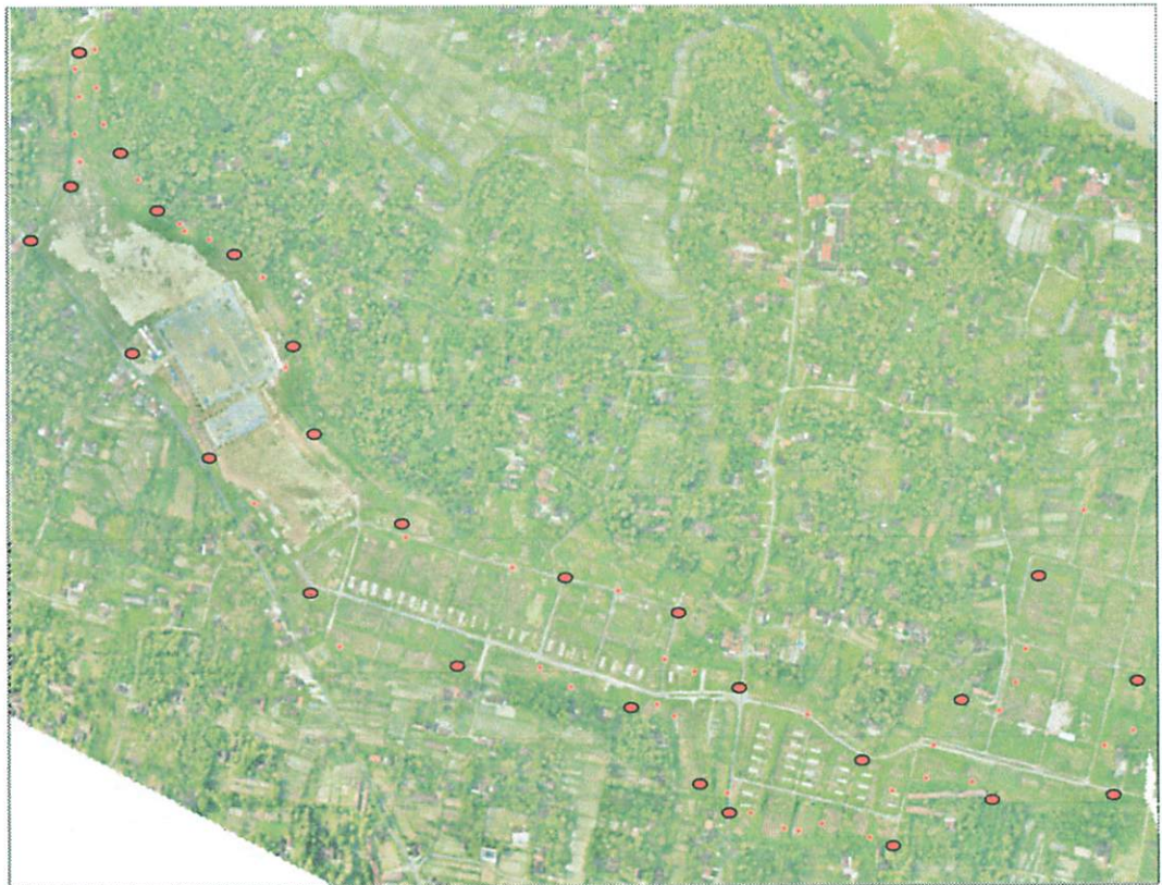
Gambar 2.4. Persebaran titik-titik kontrol pemetaan metode poligon
