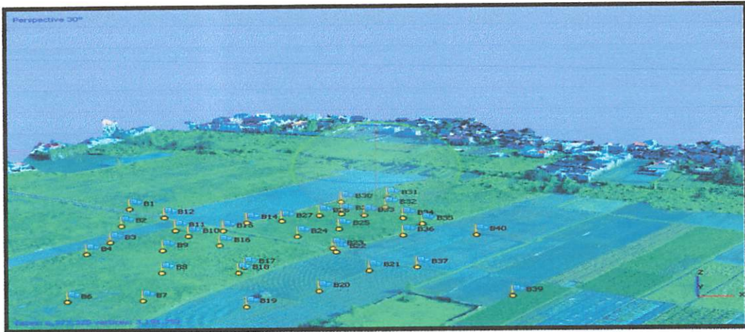
Gambar 4.3 hasil transformasi kordinat dalam point cloud
