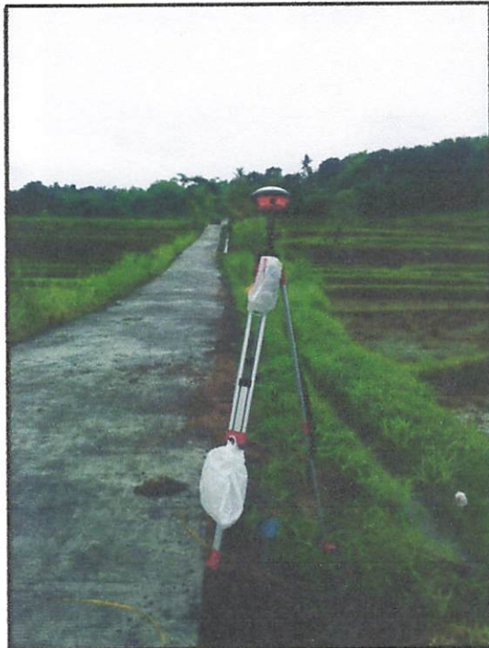
Gambar 3.3 Mendirikan DGPS Land-Pak di Bench Mark
