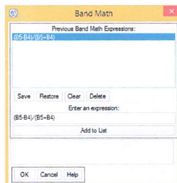
Gambar 3.35 Input algoritma NDVI
