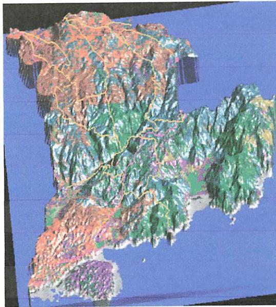
*Gambar 3.27. Overlay Data Vektor dan DEM*
