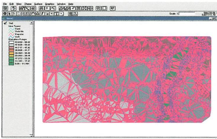
Gambar 2.32 Contoh tampilan DTM dalam bentuk TIN
