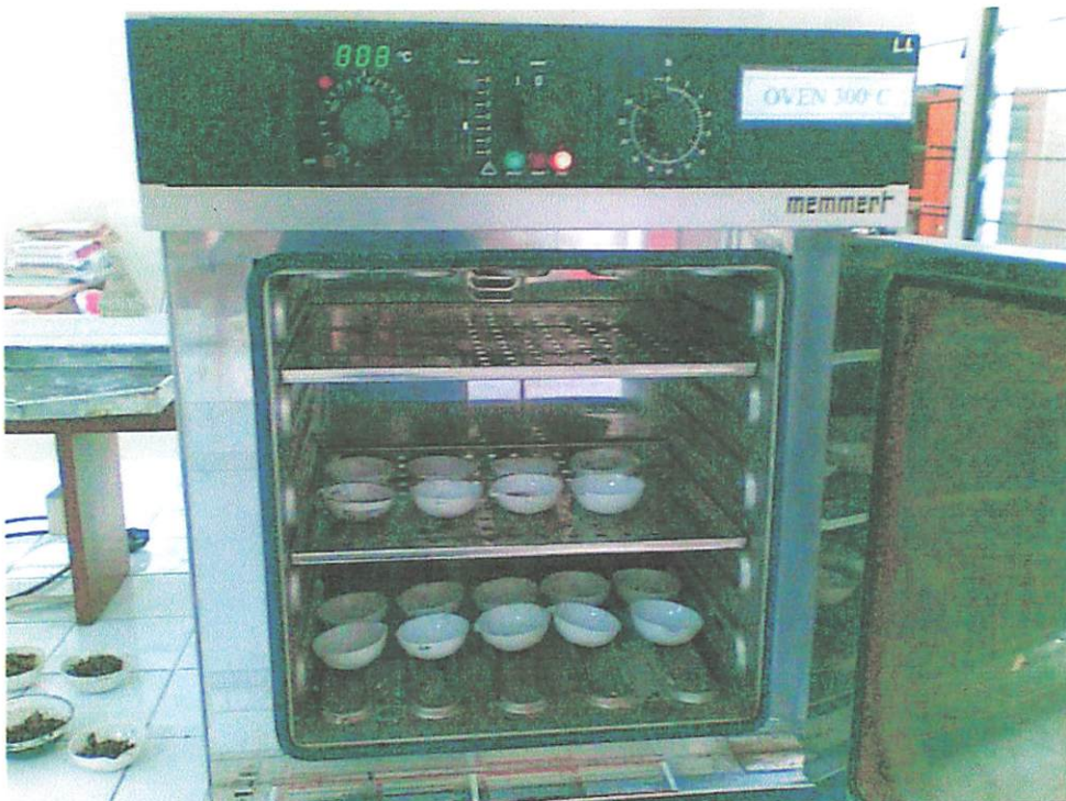
Proses Pemanasan pada Analisis Karbon
