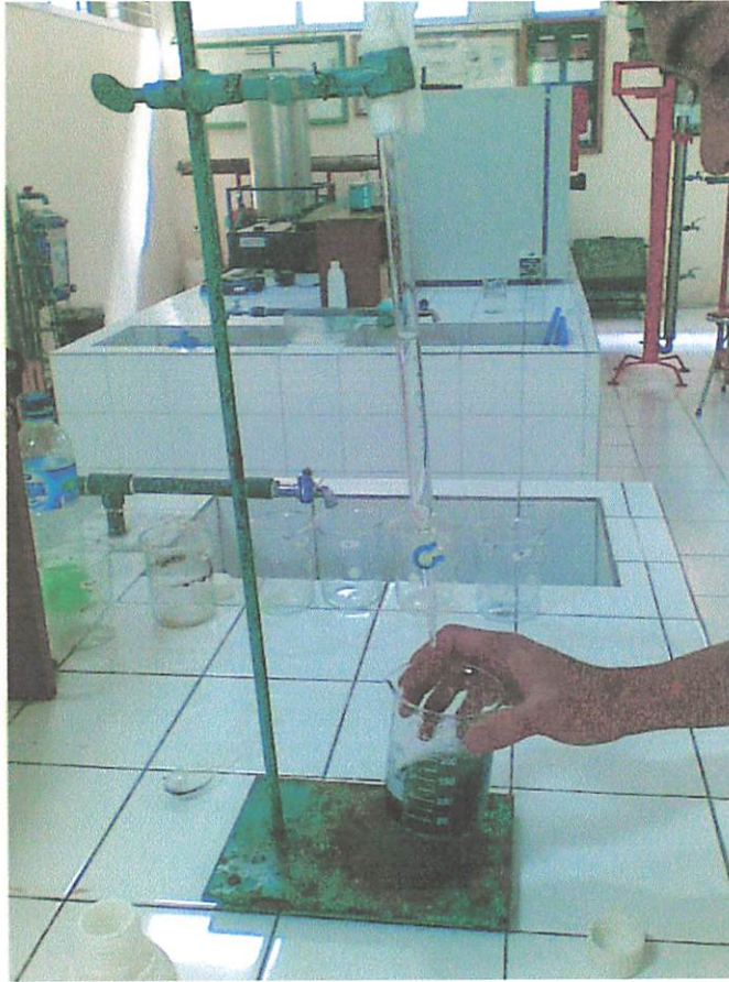
Proses Titrasi Analisis Nitrogen
