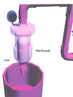
Gambar 3.1. Membran Keramik Di Dalam Tabung Reaktor
