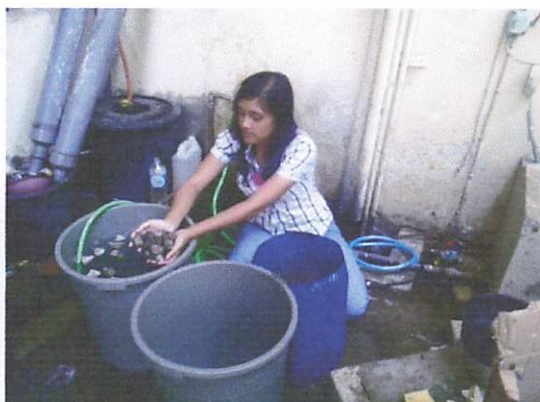
L2 Pencucian dan pembilasan dengan aquadest
