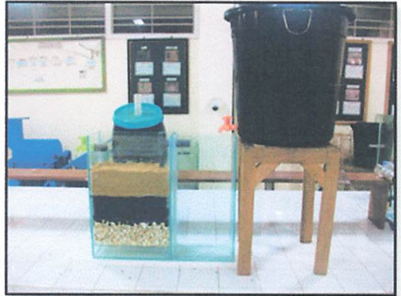
Reaktor Kolom Filtrasi dan Media
