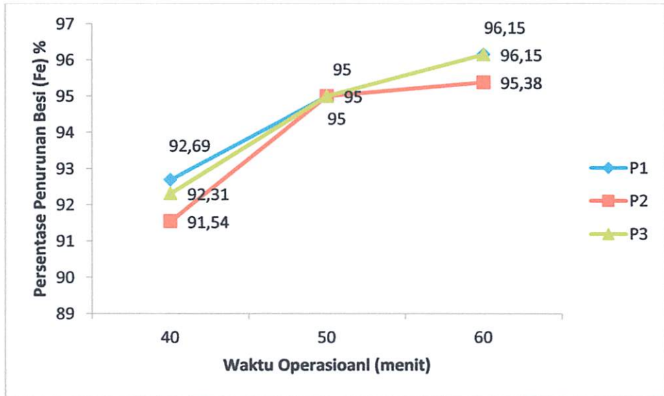
Gambar 4.7 Grafik Persentase Penurunan Besi (Fe) (%) Dengan Debit Aliran 0,5 l/menit
