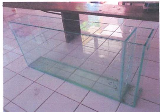
Gambar 3.1 Reaktor Bak Sedimentasi *Rectangular*
