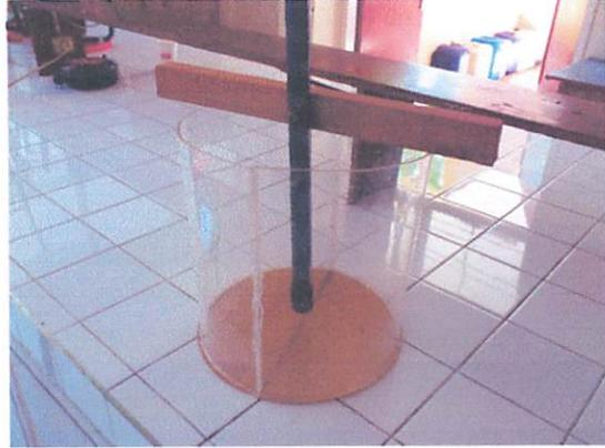
Gambar 3.2 Reaktor Bak Sedimentasi *Circular*
