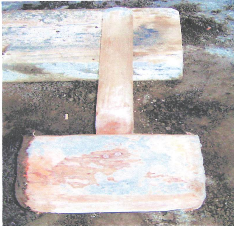
Alat tumbuk untuk menghancurkan/menghaluskan lumpur kering
