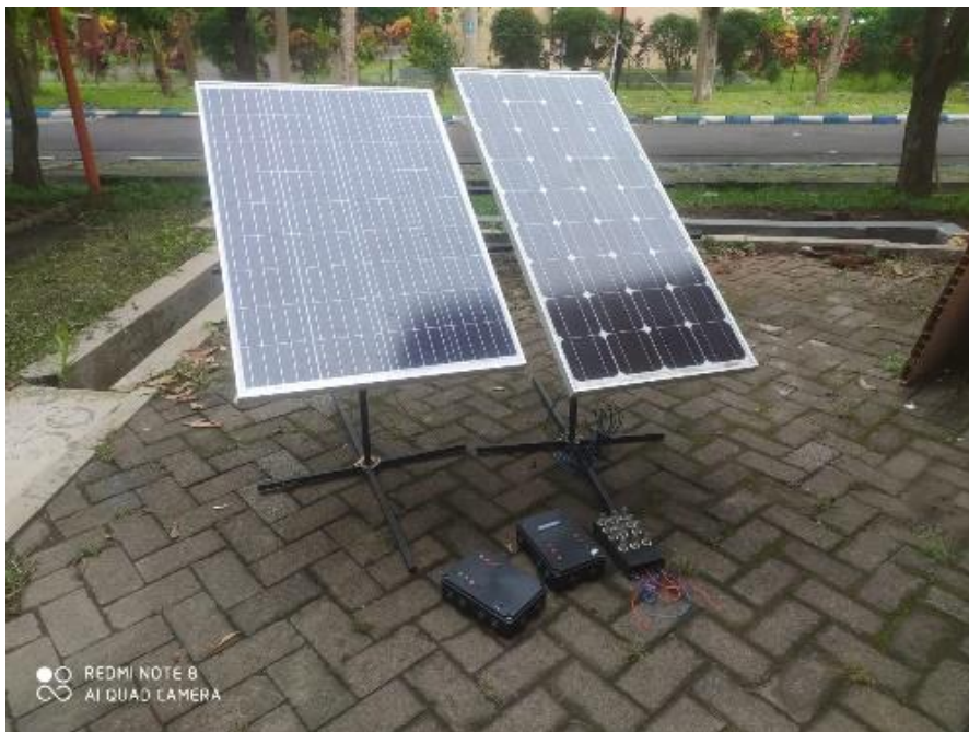
Gambar 7 – Peletakan Panel Surya, Datalogger, dan Dummy Load
