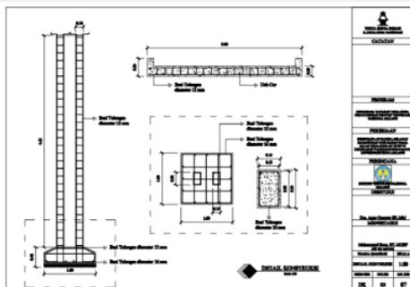
Gambar 2. Detail Konstruksi Tiang dan Atap Gapura
