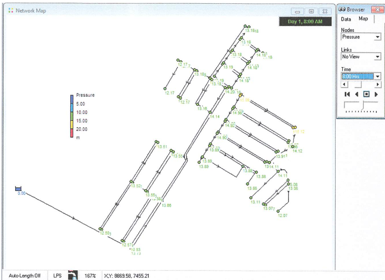
Gambar 5.5 Tampilan Hasil Simulasi Epanet 2.0 Tekanan pada jam puncak
