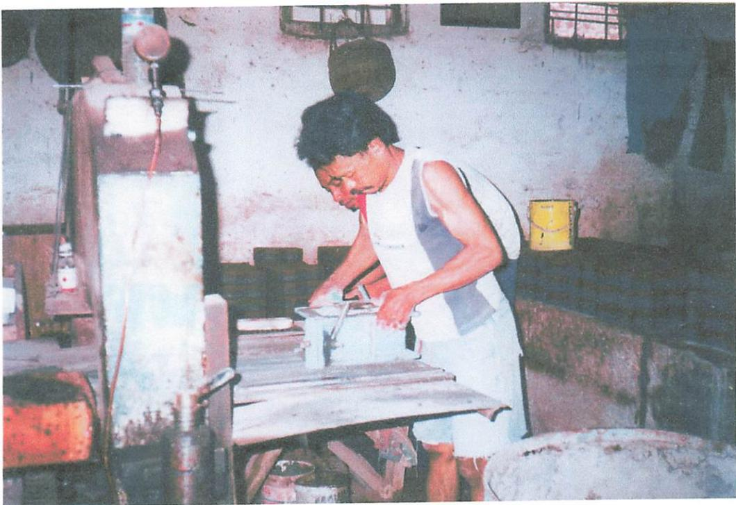
Proses pembuatan paving
