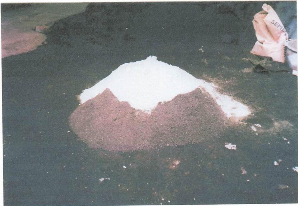
Proses pencampuran abu bakaran sampah medis dengan bahan dasar pembuatan paving
