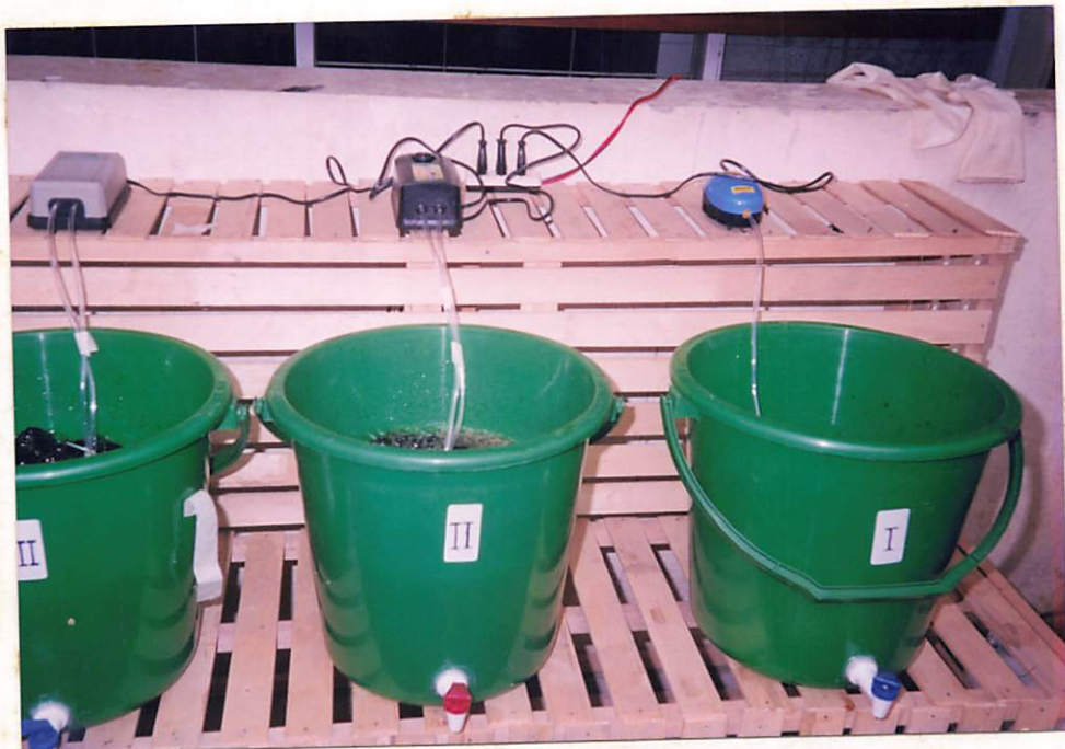
Gambar 4. Alat Pengolahan Lindi Dengan Proses Aerasi
