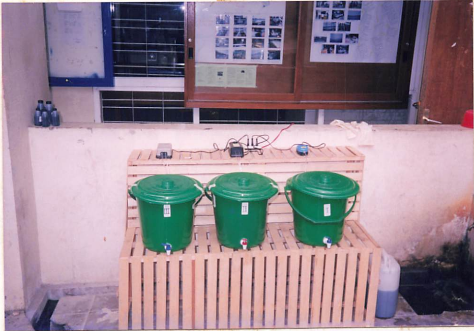
Gambar 3. Alat Pengolahan Lindi Dengan Proses Aerasi
