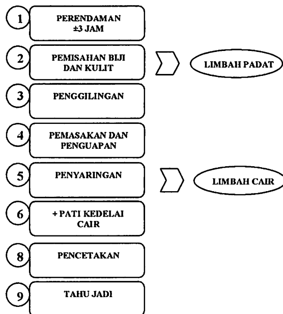
Gambar 2.1 Proses Produksi Tahu
