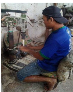
Gambar 1. 3 Posisi Pekerja Pembuatan Lubang Handle Sumber: Dokumentasi Pribadi
