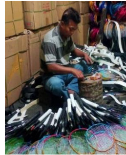
Gambar 8 Posisi Pekerja Menyulam Senar Raket Sumber: Dokumentasi Pribadi
