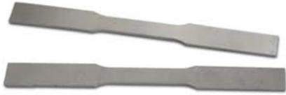
Gambar 2. Bentuk Specimen Uji Tarik
