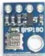
Gambar 7. Sensor Tekanan Udara BMP180
