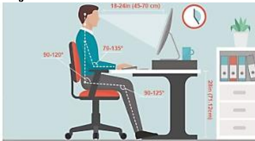
Gambar 1 Pengukuran Meja dan Kursi berdasarkan antropometri
