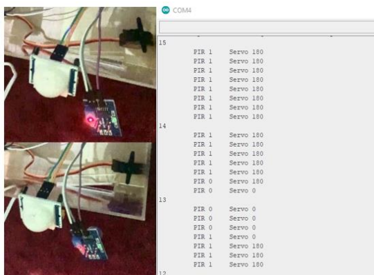
Gambar 17. pengujian sensor pir dan microservo
