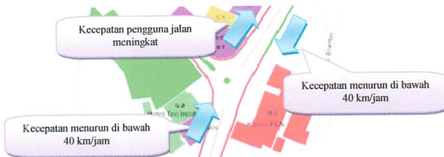
Gambar 5.21 Perkiraan Kecepatan Pengguna Jalan Di Lokasi Potensial Sub 7-Segmen 4
