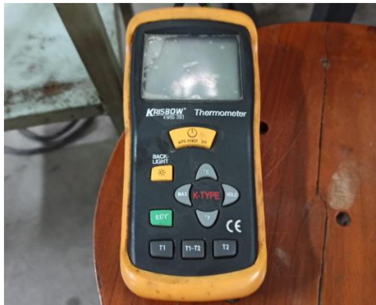
Gambar 4 : Thermometer digunakan sebagai alat pengukur T1 dan T2 bahan bakar yang melewati pipa lilitan kawat tembaga
