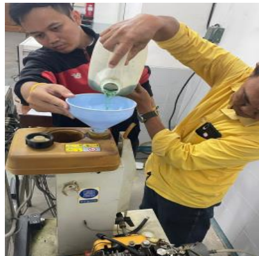
Gambar 3. 8 Proses Persiapan Memasukkan Bahan Bakar (Sumber : Hadi., 2023)
