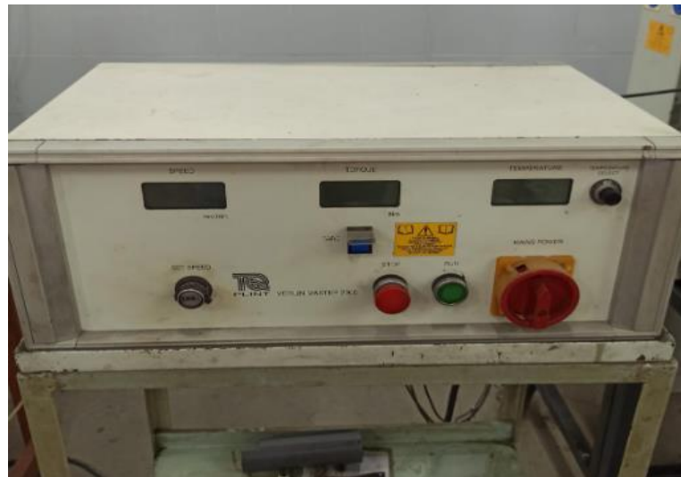
Gambar 2 : Alat Dyno Test digunakan untuk mengukur performa mesin mulai dari Daya (Ne), Torsi (Td), dan untuk mengatur Putaran Mesin (RPM)
