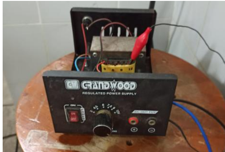
Gambar 5 : Adaptor atau Travo sebagai alat untuk mengatur variasi kuat arus listrik pada setiap pengujian
