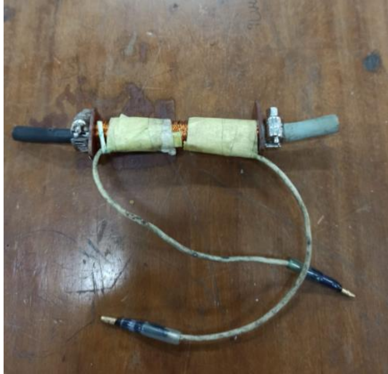
Gambar 1 : Pipa lilitan kawat tembaga berdiameter kawat 0,20 mm digunakan sebagai pipa bahan bakar untuk penelitian
