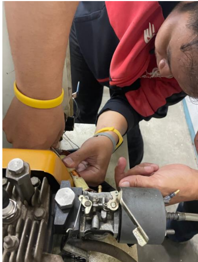
Gambar 6 : Proses pemasangan pipa lilitan kawat tembaga pada mesin Merlin 1
