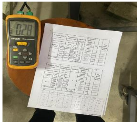
Gambar 3. 11 Proses Pencatatan Hasil dari Thermocouple (Sumber : Hadi., 2023)
