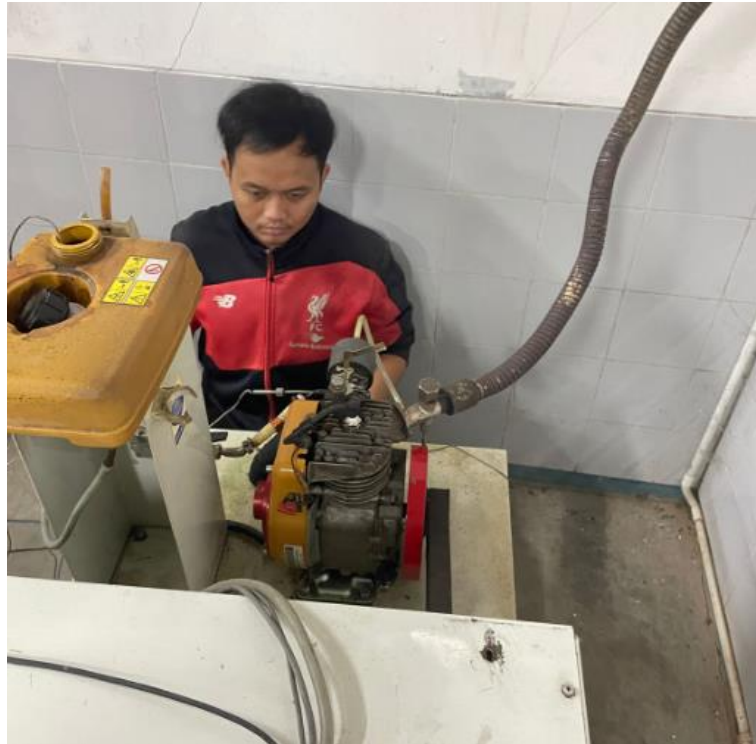
Gambar 11 : Proses pengamatan dan pencatatan hasil dari konsumsi bahan bakar (SFC)
