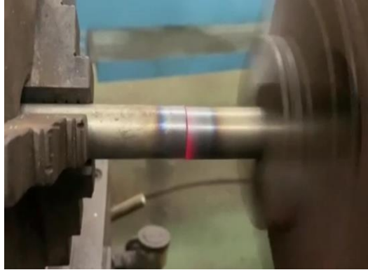
Gambar 3.7 Proses Pemanasan Permukaan Dengan Gesekan
