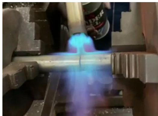
Gambar 3.5 Pemanasan Bahan Yang Akan Di Las
