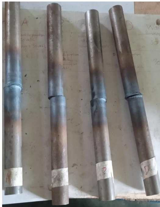
Gambar 3.9 Baja AISI 1045 Hasil Pengelasan Gesek
