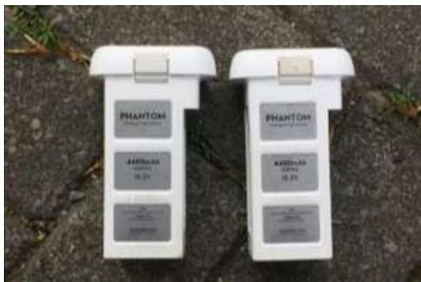
Gambar 4.18 Baterai yang digunakan li-po (Lithium polymer)
