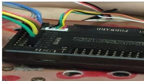
Gambar 3.7 Menghubungkan *Flight Controller* Dan Memasang GPS
