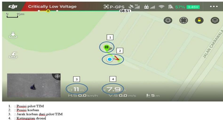
Gambar 4.32 Keterangan gambar yang dapat di lihat pada layar Hp (sumber:Dokumen Pribadi dari aplikasi *live view drone quadcopter* pada *handphones* atau telefon genggam)
