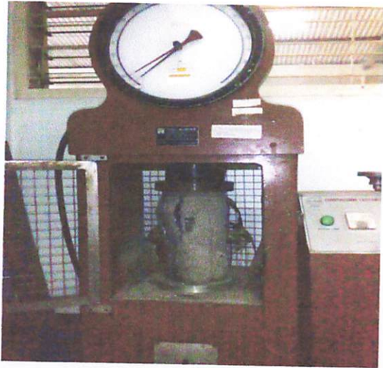
Gambar Pengujian Kuat Tekan Pada Silinder
