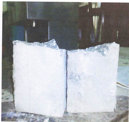
Gambar Benda Uji Bata setelah Uji Kuat Lentur
