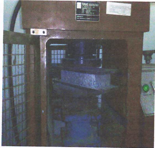
Gambar Pengujian Kuat Tekan Pada Mortar dan Bata
