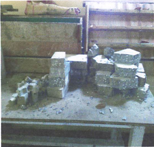
Gambar Benda – benda Uji setelah Uji Kuat Tekan dan Lentur
