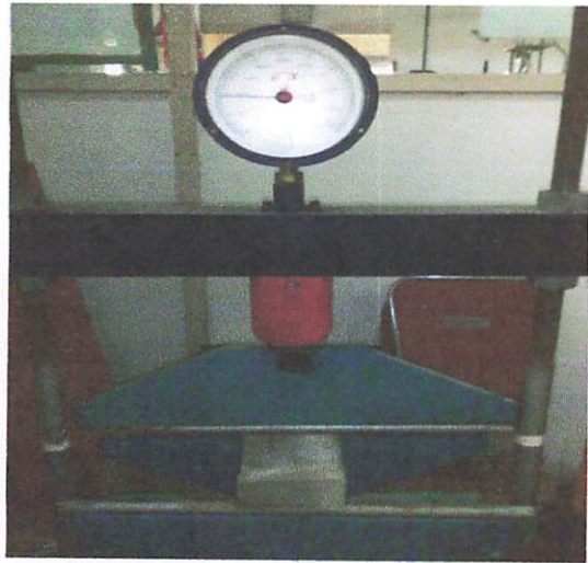
Gambar Pengujian Kuat Lentur Pada Bata
