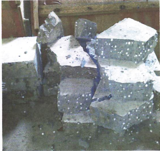
Gambar Benda – benda Uji setelah Uji Kuat Tekan dan Lentur
