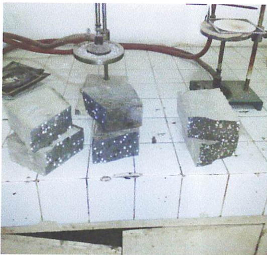
Gambar Benda Uji Bata setelah Uji Kuat Lentur
