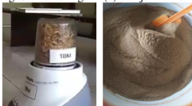
Gambar 8. Proses blender jerami nangka agar menjadi serbuk (kiri) dan setelah diayak (kanan)
