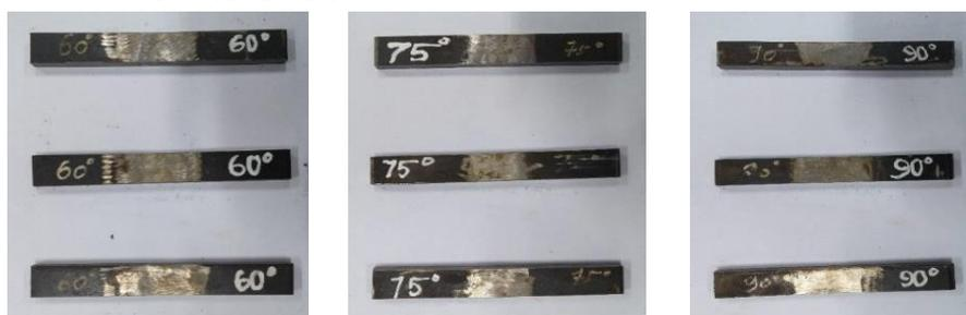
Gambar 3. Spesimen Uji Bending Sebelum Dilakukan pengujian
