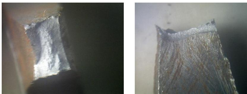
Gambar 6. Struktur Makro Hasil Foto Patahan Uji Tarik Baja St.42 60°
