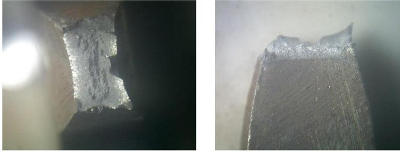
Gambar 7. Struktur Makro Hasil Foto Patahan Uji Tarik Baja St.42 75°
