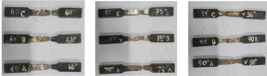
Gambar 4. Spesimen Uji Tarik Setekah Dilakukan pengujian
