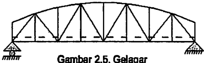
Gambar 2.5. Gelagar Setengah Parabola
