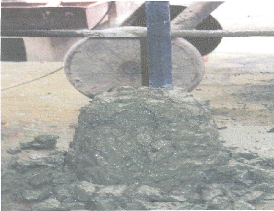
Slump Test Beton dengan Campuran Additive
