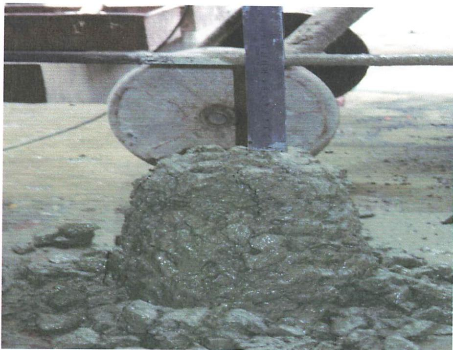
**Slump Test Beton dengan Campuran Additive**
