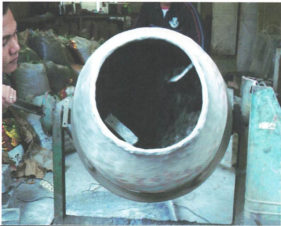
**Pencampuran Material Beton Normal**
