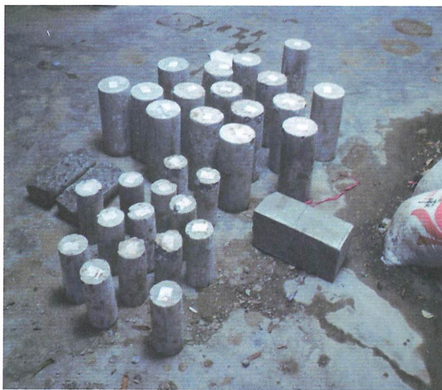
**Hasil Benda uji yang telah di Test**
