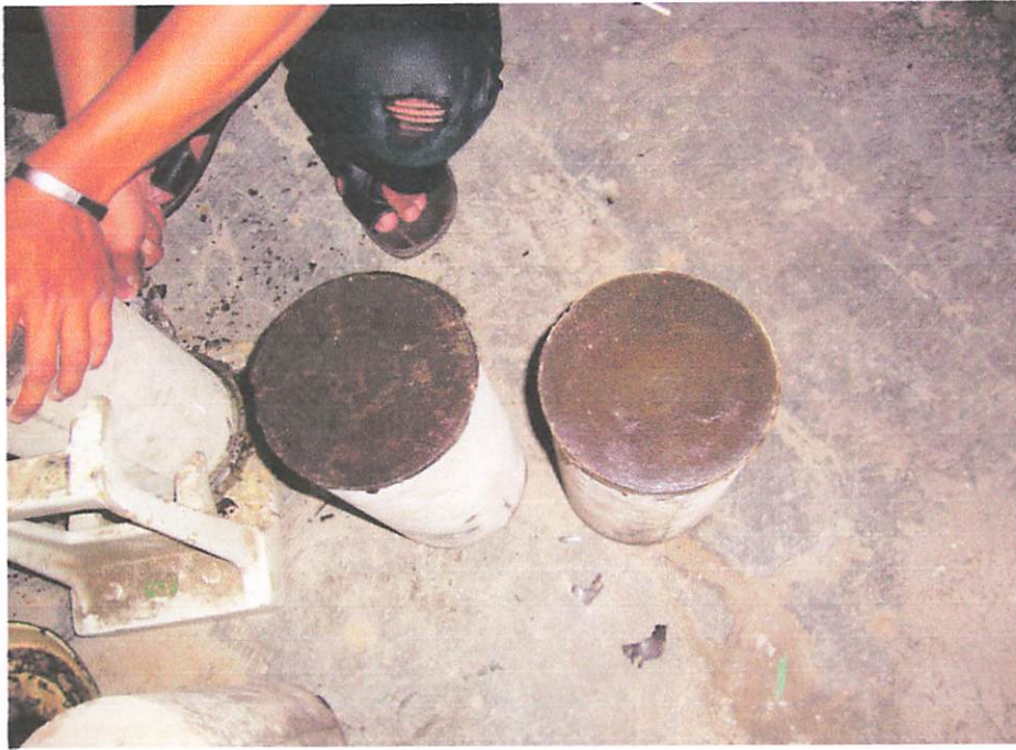
Silinder setelah dikeping
