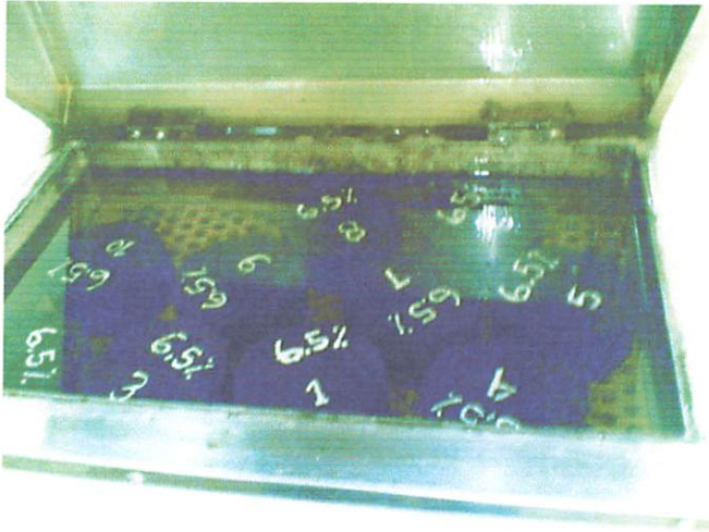
Gambar 3.22. Perendaman Sampel Dalam Waterbath dengan Suhu 60^{\circ}\text{C}
