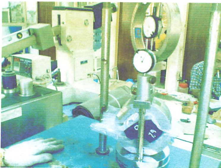
Gambar 3.23. Pengujian Sampel dengan Alat Tes Marshall
