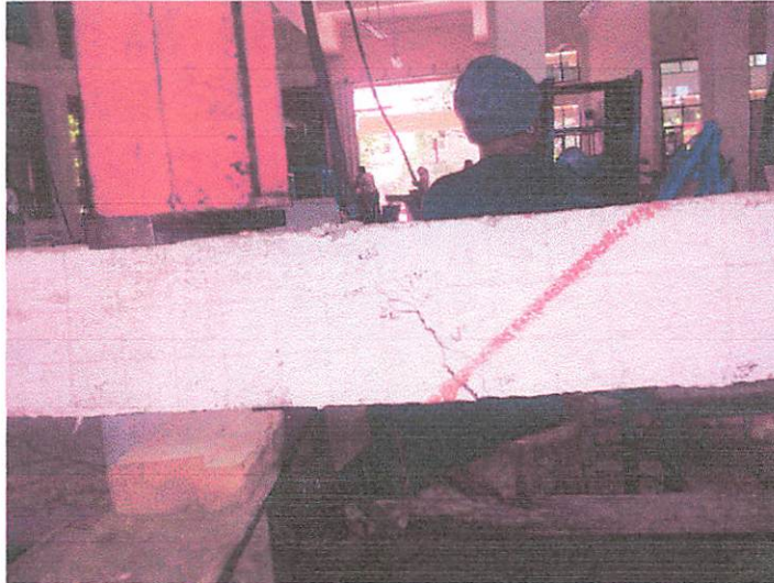
Gambar 4.9 Pola retak balok dengan jarak sambungan beton dan tulangan sepertiga bentang A (1/3)
