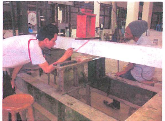
Pengujian rekam retak
