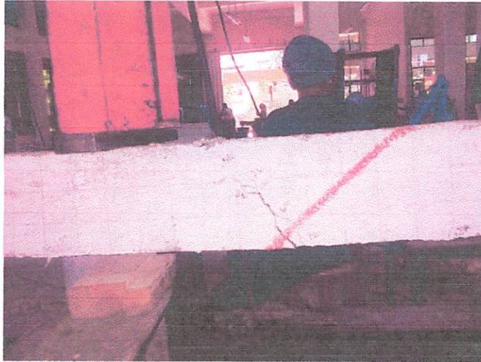
Gambar 4.4 Pengujian Kuat lentur balok dengan jarak sambungan beton dan tulangan sepertiga bentang (1/3)A
