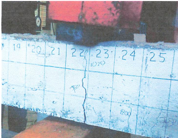
Gambar 4.6 Pola retak balok tanpa sambungan (BTS)-A
