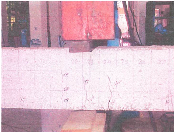
Gambar 4.8 Pola retak balok tanpa sambungan (BTS)-C
