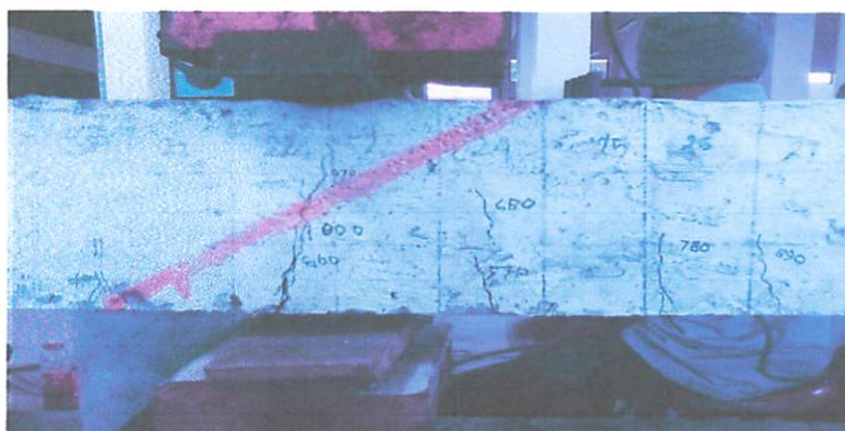
Gambar 4.4 Pengujian Kuat lentur sambungan balok beton dan tulangan dengan jarak seper-dua bentang ( 1/2- A )
