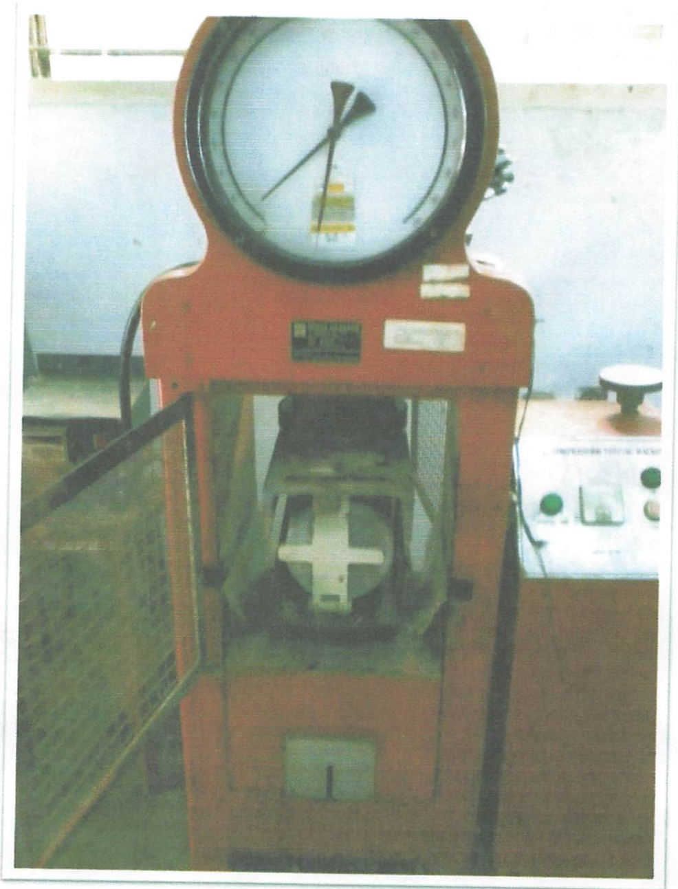
PENGUJIAN KUAT TARIK BELAH BETON
