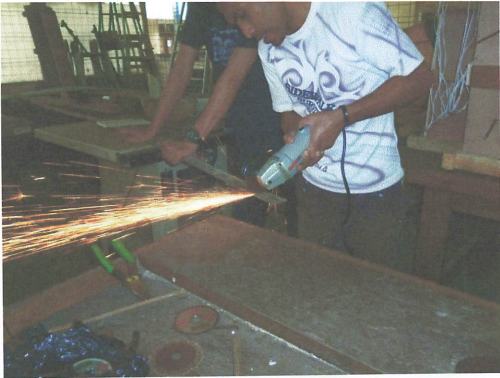
Foto : Proses Pemotongan Plat Strip Untuk Tumpuan Eldivity
