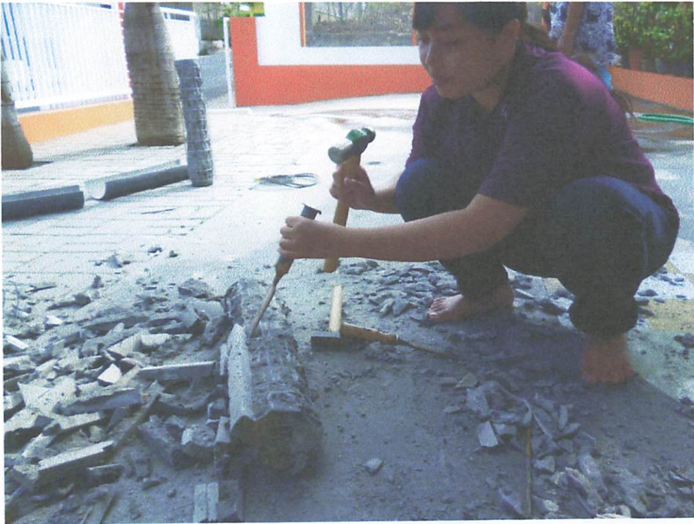
Foto : Proses Pengupasan Benda Uji Untuk Dililit Fine Mesh
