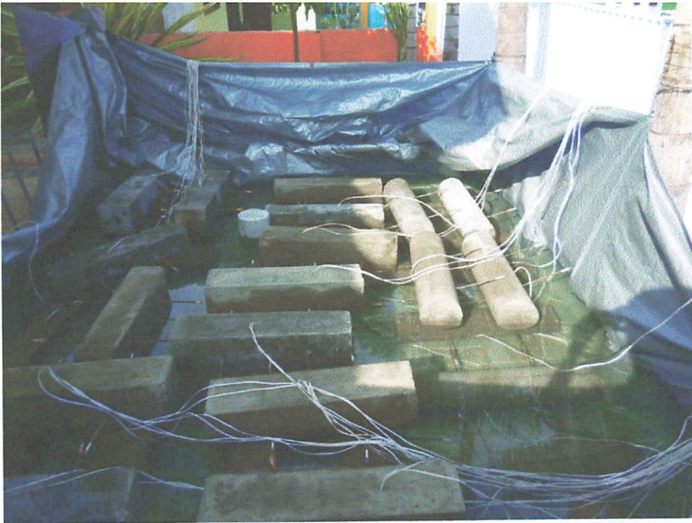
Foto : Proses Perendaman Benda Uji
