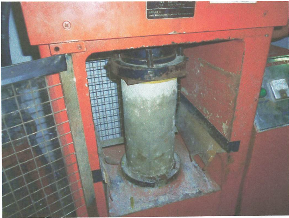
Foto : Pengujian Silinder Beton
