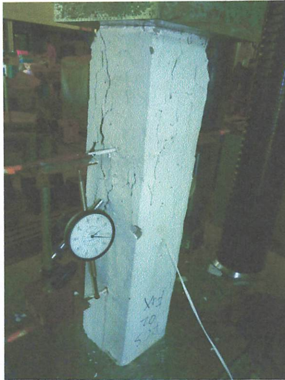
Gambar 4.3 Spalling Pada Kolom RCS_2 P = 36,5 ton dan \epsilon'_{cu} = 0,00221
