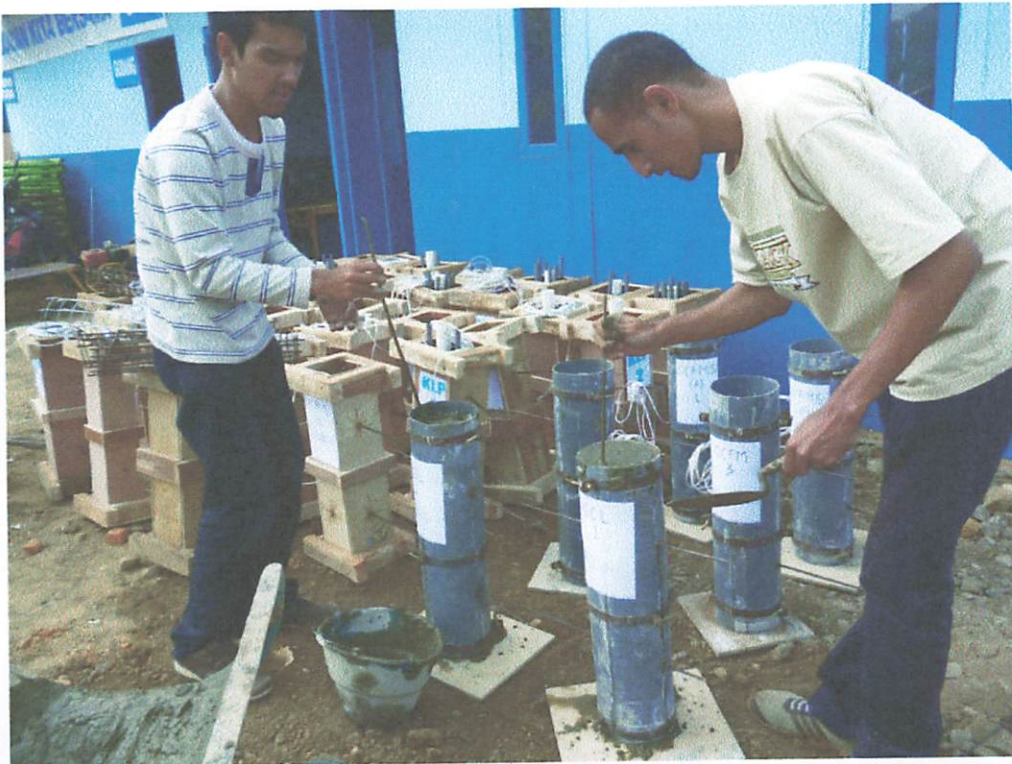
Foto : Pengecoran Benda Uji
