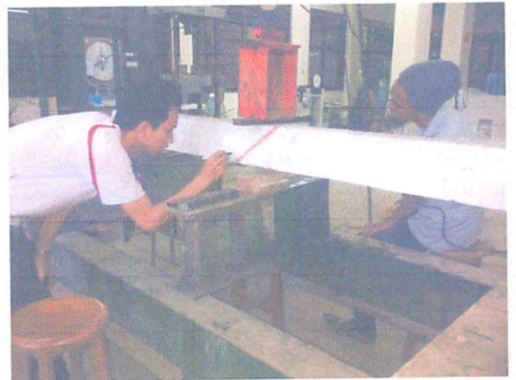
Pengujian rekam retak
