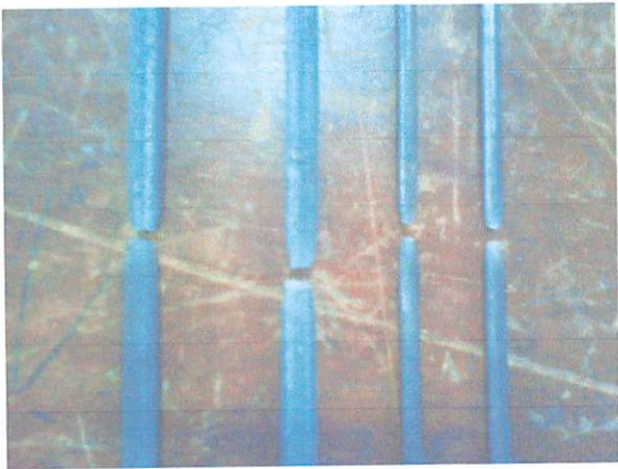
Hasil pengujian besi tulangan % sengkang
