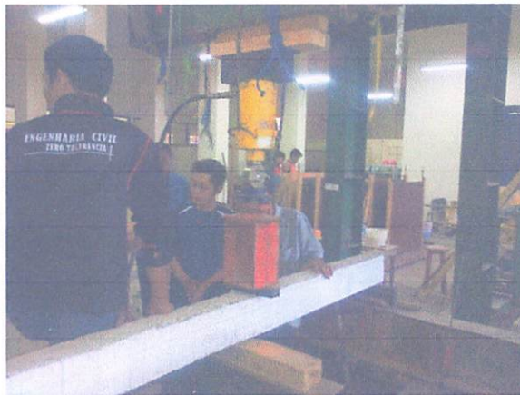
Gambar 4.2 Pengujian Kuat lentur balok tanpa sambungan B (BTS-B)
