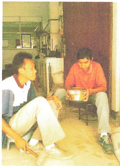
Gambar Pengerjaan Ayakan Lolos Saringan No.40
