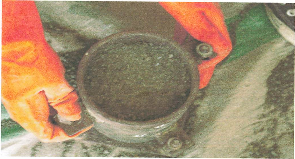
Gambar Benda Uji Compaction dan CBR
