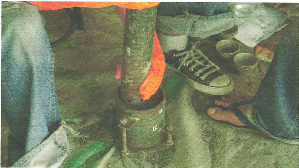
Gambar Pelaksanaan Compaction dan CBR
