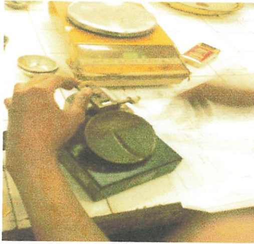
Gambar Pelaksanaan dan Alat Pengujian Test PI, LL, PL
