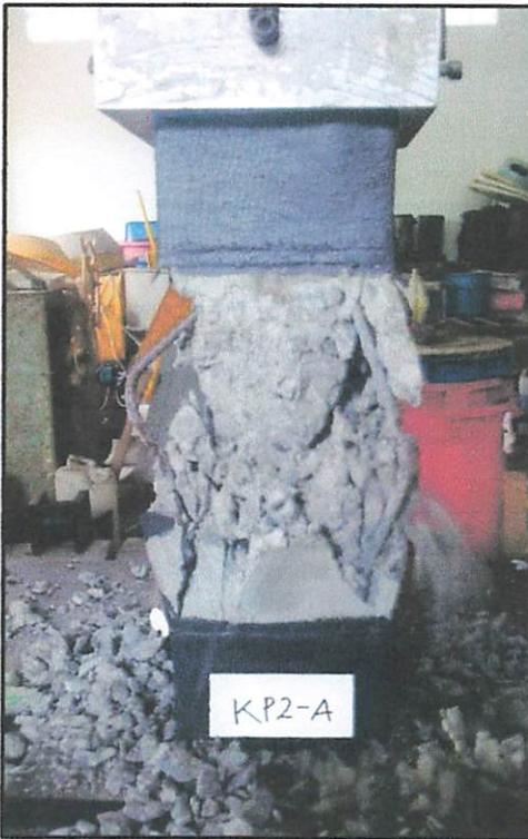
Foto 2.8 : Pengujian kolom KP2-A
