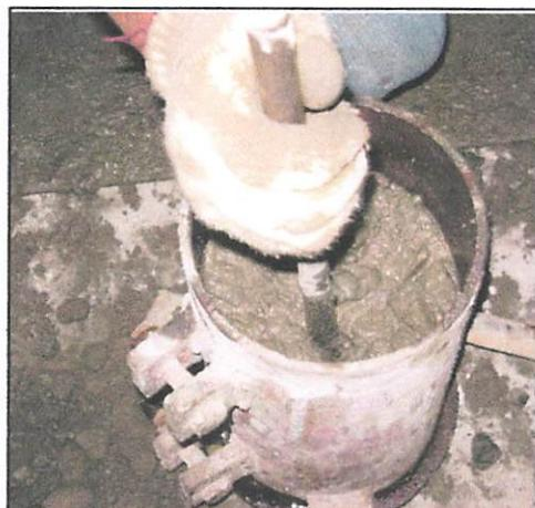
**Foto 1.3 : Pemasangan Benda Uji Silinder**
