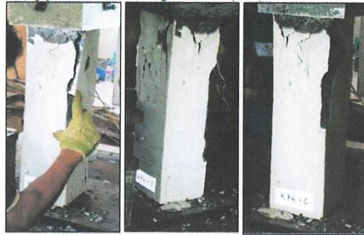
5. Pengujian Kolom Terkekang BJTP O 6 dan CFRP (KP5)
