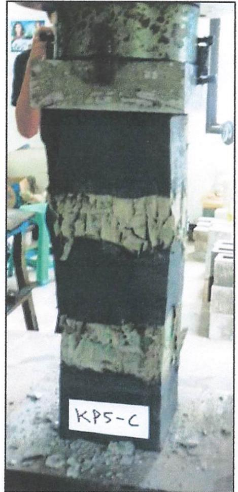
Foto 2.15 : Pengujian kolom KP5-C
