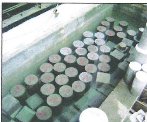
**Foto 1.5 : Perawatan Silinder Beton**
