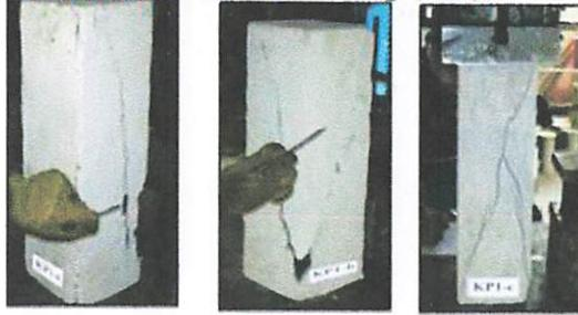
2. Pengujian Kolom Terkekang CFRP (KP2)
