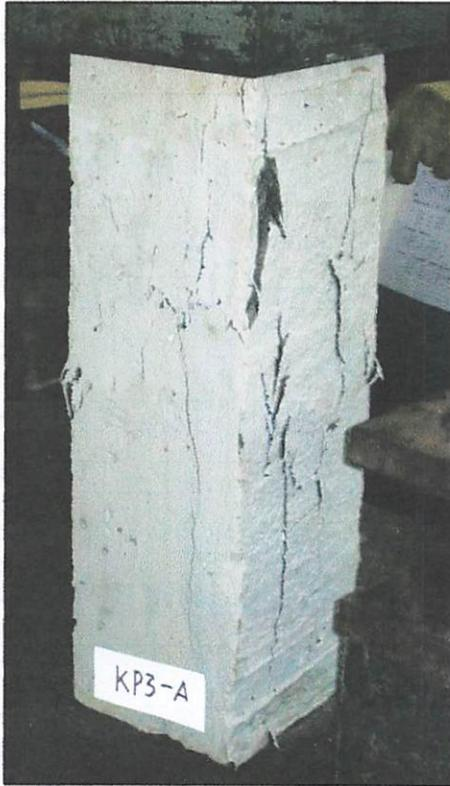
Foto 2.10 : Pengujian kolom KP3-A
