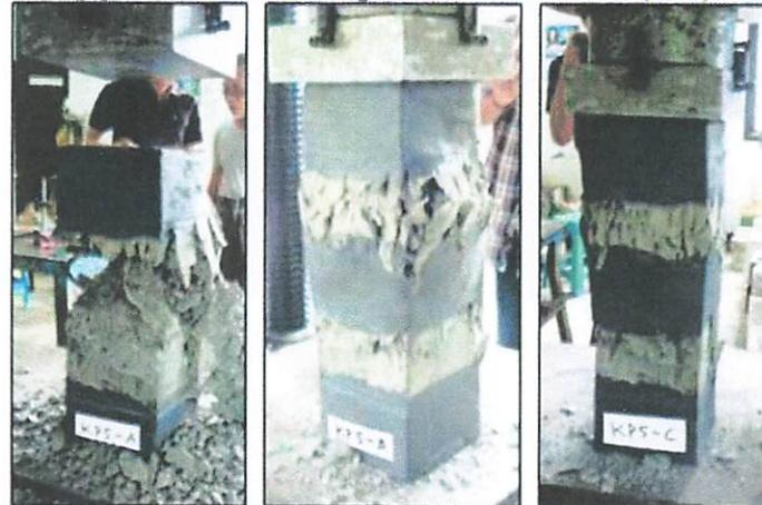
Gambar 4.6. Foto Pengujian Kolom
