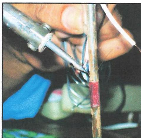
Foto 2.2 : Pemasangan Strain Gauges
