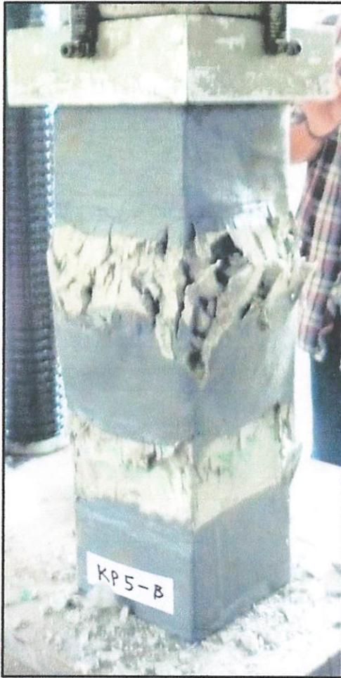
Foto 2.14: Pengujian kolom KP5-B
