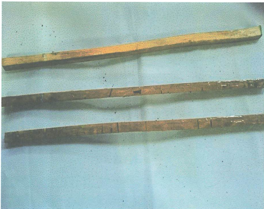
Gambar 4.4: pengecatan lem pada tulangan bambu
