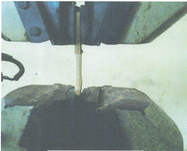
Gambar 5.6 : uji tarik bambu
