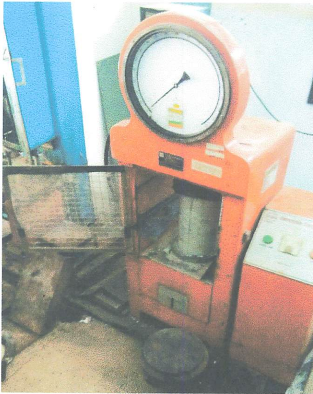
Gambar 4.7: alat uji tekan beton
