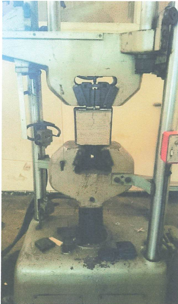
Gambar 3.4 gambar uji kekuatan lekatan menggunakan alat uji tarik Universal Testing Machine
