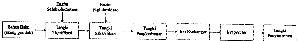
Gambar 2.1.1. Blok diagram Proses Pembuatan Sirup Glukosa dengan Proses Hidrolisis Enzimatis (Shuler, 2002)
