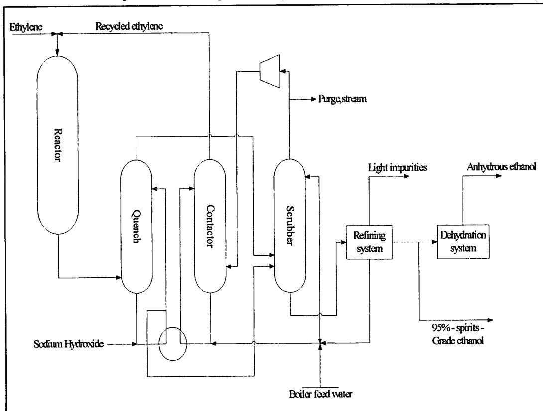
Gambar 2.2 Blok diagram proses esterifikasi dan hidrolisis dari ethylene
