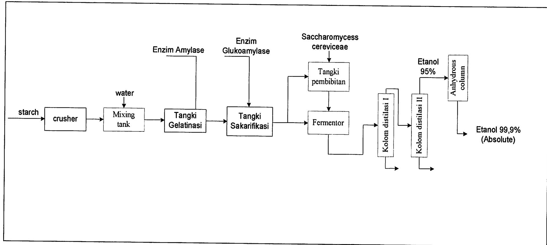
Gambar 2.3 Blok diagram proses pembuatan bioethanol dengan proses hidrolisis dan fermentasi
