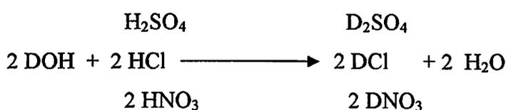
Sehingga keluaran dari tangki demineralisasi adalah garam-garam kalsium, natrium dan magnesium yang terikat pada kation *exchanger* dalam bentuk  $\text{CaZ}$ ,  $\text{NaZ}$  dan  $\text{MgZ}$ . Sedangkan  $\text{H}_2\text{SO}_4$ ,  $\text{HCl}$  dan  $\text{HNO}_3$  terikat pada anion *exchanger* dalam bentuk  $\text{D}_2\text{SO}_4$ ,  $\text{DCl}$  dan  $\text{DNO}_3$ . Setelah keluar dari demineralisasi, air umpan boiler telah bebas dari ion-ion pengganggu.
