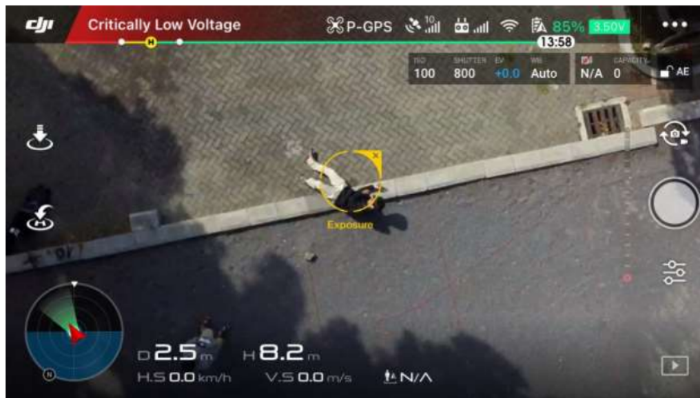
Gambar 4.8. Pengujian quadcopter untuk mendeteksi Obyek (Korban Bencana) dengan ketinggian 2 meter , GPS 3, dengan sinyal telemetry 99%.
