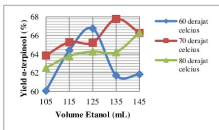
Gambar 5. Hubungan antara Yield  $\alpha$ -terpineol dengan Volume Etanol pada Berbagai Suhu Reaksi
