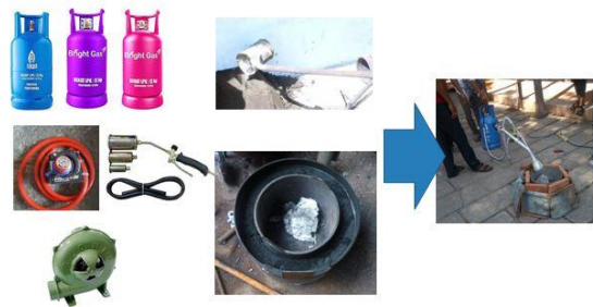
Gambar 4. Alat dan Bahan untuk Proses Pengecoran Sederhana
